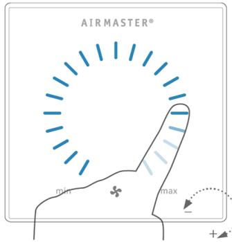
La unité repasse au fonctionnement automatique après 12 heures (le délai peut être réglé sur 0, 1, 2... 255 heures à l'aide d'un PC équipé du programme Airlinq Service Tool).
