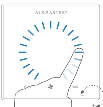
Après 12 heures (la durée peut être réglée sur 0, 1, 2, ... 255 heures à l'aide d'un PC équipé du logiciel Airlinq Service Tool), L'unité repasse en mode automatique.
