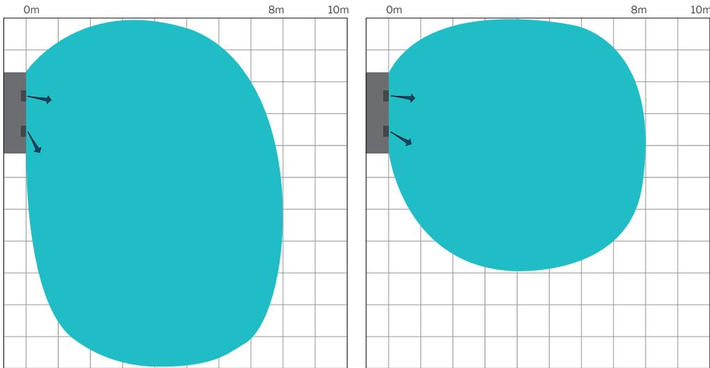
Diffusion d'air asymétrique<sup>15,16</sup> avec Adaptiv Airflow™ et grille de soufflage directionnelle vers la droite.
