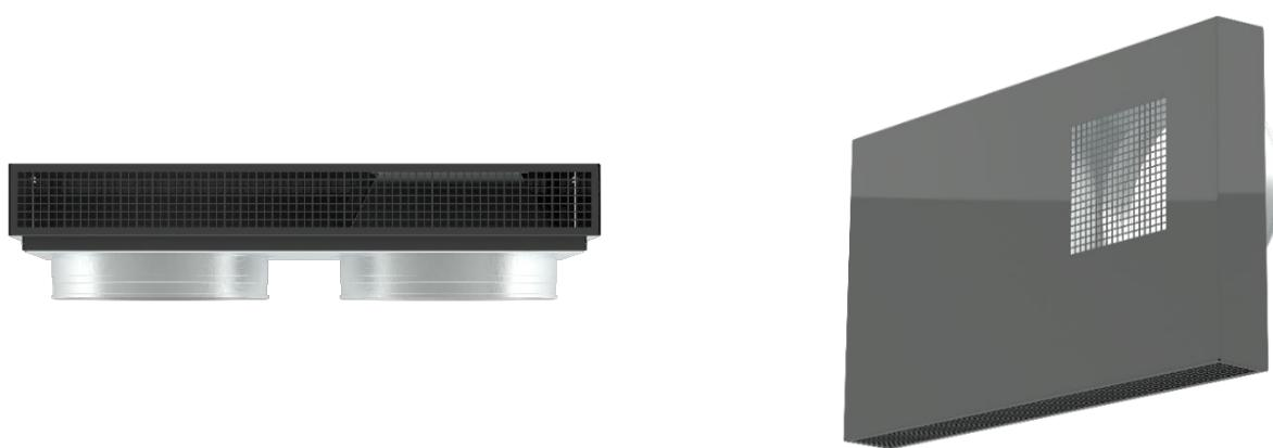
Ce couvercle est conçu comme un écran fixe pour l'AM 900 lorsque air soufflé et air rejeté sont proches. Il protège contre les courts-circuits externes en séparant l'admission par le bas du couvercle et l'évacuation par la grille verticale à l'avant.
