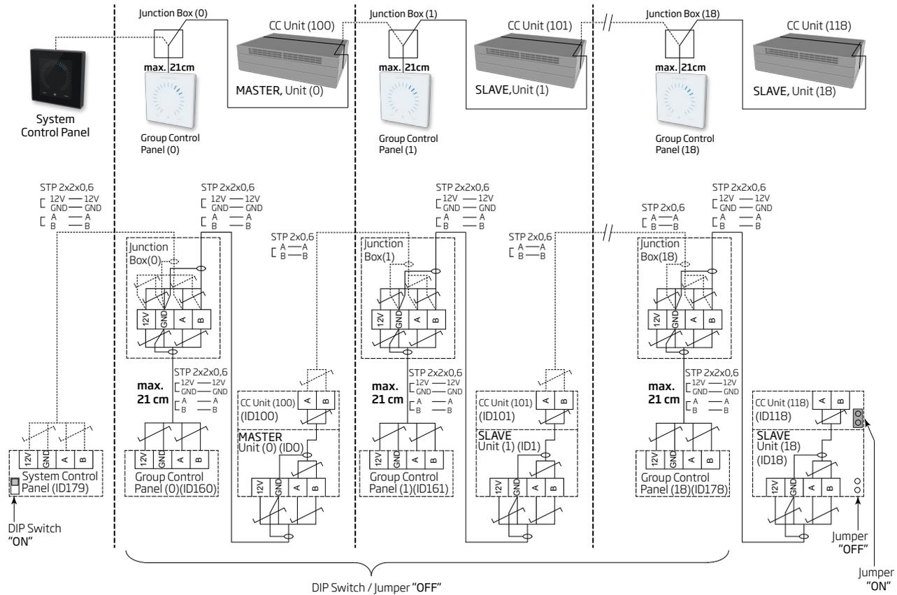
La boîte de distribution (Junction Box) doit être montée à proximité immédiate du pupitre. Toute autre longueur de câble (max. 21 cm) est interdite et pourrait entraîner des erreurs de communication.
