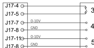
L'A-BMS applique le signal de sortie 13,5 V c.c. via un contact de fermeture (NO) (3) de la borne J17-4 sur la borne J17-5 (AI#1). La centrale est alors démarrée et arrêtée conformément à la programmation de l'A-BMS.
