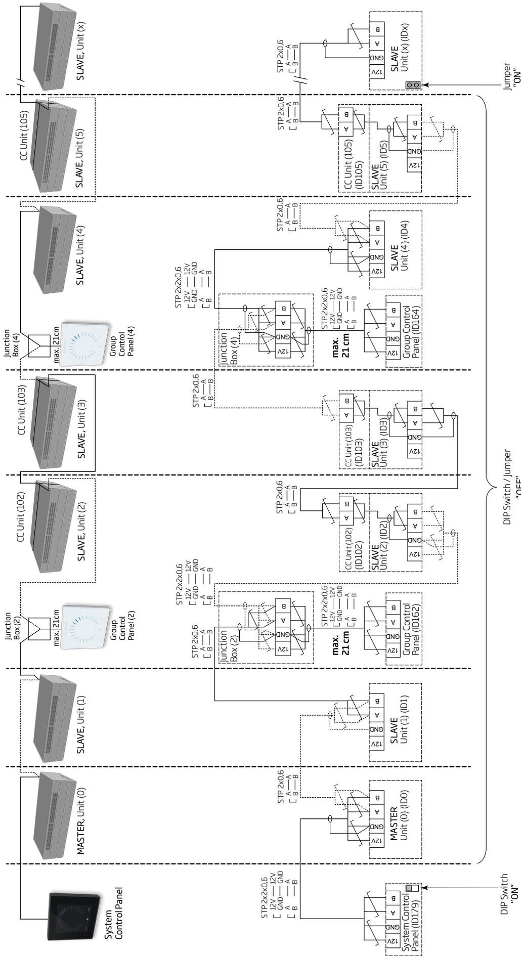
La boîte de distribution (Junction Box) doit être montée à proximité immédiate du pupitre. Toute autre longueur de câble (max. 21 cm) est interdite et pourrait entraîner des erreurs de communication.
