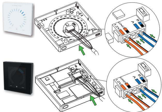
La livraison comprend un pupitre de commande joint sous forme de pièce détachée ainsi qu'un câble de données prémonté de 3 m. Le pupitre doit être monté à une hauteur adéquate sur le mur, généralement dans la même pièce que la centrale. Toutefois, il peut également être positionné dans un local adjacent.
